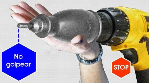
4 - Enroscando la tuerca completamente.
